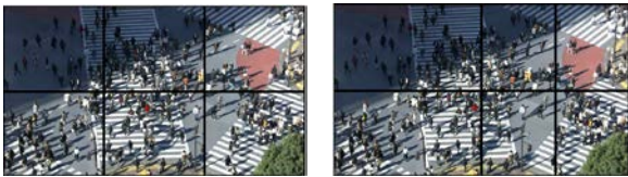
그림 2: HEVC 공식 테스트 영상(PeopleOnStreet)을 (a)균등한 크기, (b)각 코어의 처리능력을 고려한 타일로 분할한 모습
